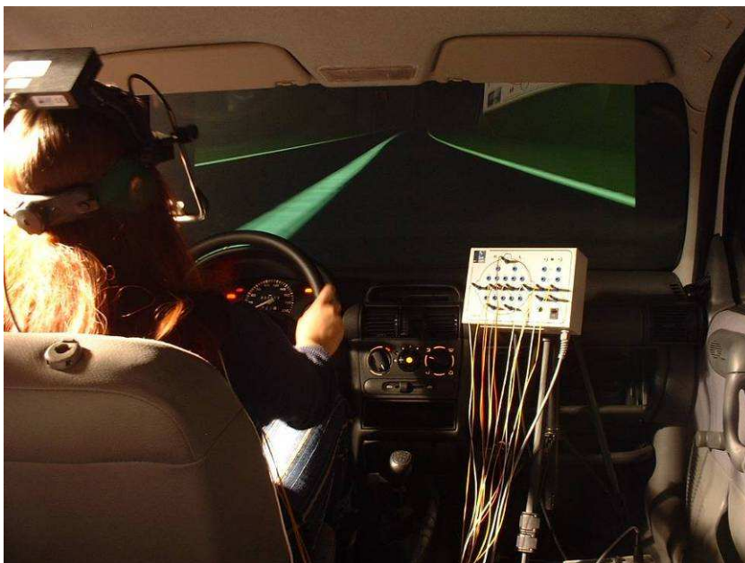
Fahrsimulation (Opel Corsa) mit Aufzeichnung von bioelektrischen Signalen und von Blickbewegungen (Eyetracking)
